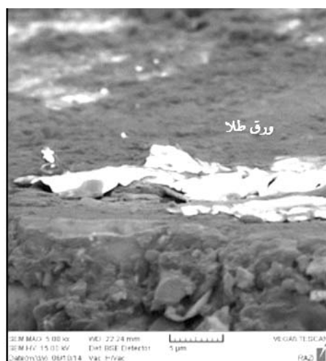
تصویر ۶: تصویر میکروسکوپی حضور ورق طلا در لایه زراندود لعاب مینایی روی نمونه M111 را نشان می‌دهد.
