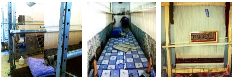
تصویر ۲: مقایسه دارهای قالی‌بافی در فرش‌نابین: راست) دار چوبی، وسط و چپ) دار آهنی برای تولید فرش‌های بزرگ در مکان‌های جدید (نگارنده).
