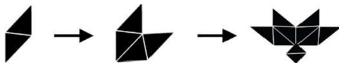
تصویر ۱۴: روند ساخت چهاربرگ با لوزی (تخم تَرک) و نمونه تصویری آن
