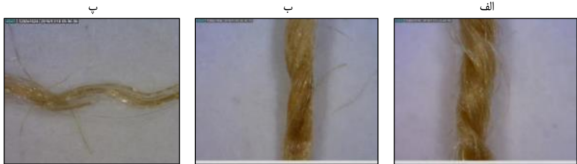
تصویر ۹: الف) الیاف تار؛ ب) الیاف پود ضخیم؛ پ) الیاف پود نازک ابریشمی به کمک لوپ دیجیتال، بزرگ‌نمایی ۲۰۰ برابر
