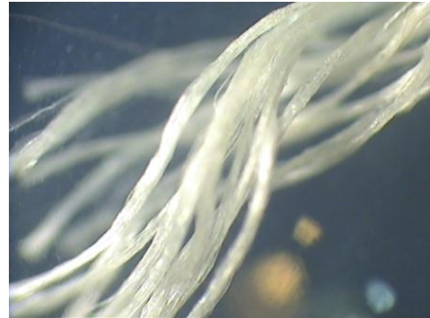
تصویر ۶: تصویر میکروسکوپ الکترونی با بزرگ‌نمایی ۲۰۰ برابر از لیف به کاررفته در گلیم‌باف (نگارندگان)
