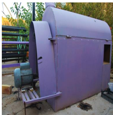
تصویر ۴: از سمت راست، دستگاه مو وزنی و دستگاه حلاجی برقی (همو، ۱۴۰۱)
