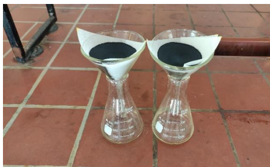
تصویر ۲: صاف کردن مخلوط دوده و تتراکلرید کربن (نگارندگان)
